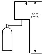
FIGURE 5-3 MAXIMUM ELEVATION BETWEEN NOZZLES
