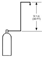
FIGURE 5-2 MAXIMUM ELEVATION BETWEEN NOZZLES AND CONTAINER OUTLET
