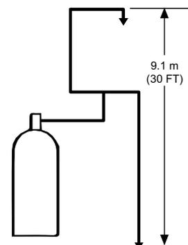
**FIGURE 5-3 MAXIMUM ELEVATION BETWEEN NOZZLES**
